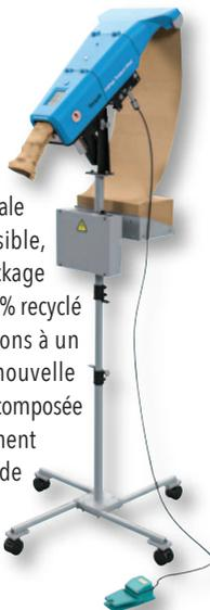
qui permettent de réduire la consommation moyenne de papier de 20 à 25% par rapport aux autres machines à base de papier. Spécialement conçue pour répondre aux besoins de remplissage, cette innovation assure un blocage, un calage et une fixation supplémentaires, garantissant une livraison sûre du produit lors du transport.
